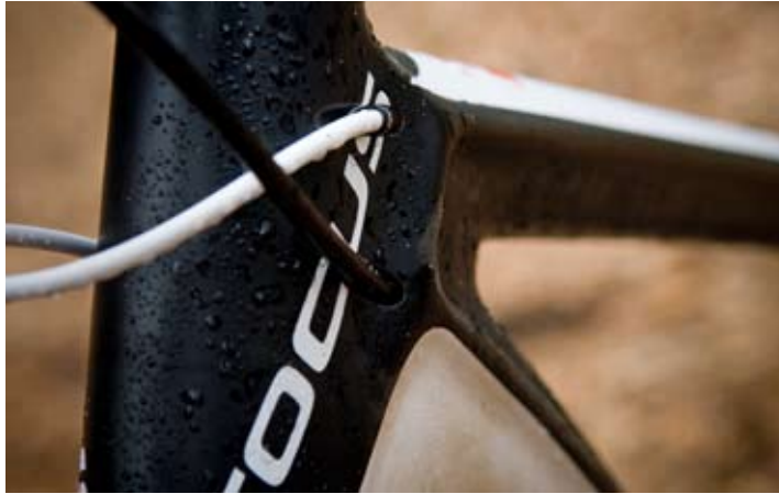
De kabelbuizen versterken het frame: dubbel functioneel dus!
